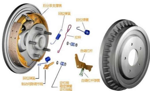
图 21：鼓式制动器结构
