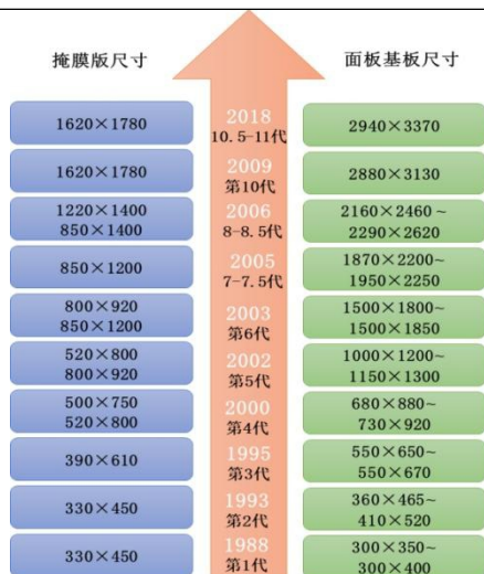
图 27: 显示面板及掩膜版世代发展简图 (单位: mm)
