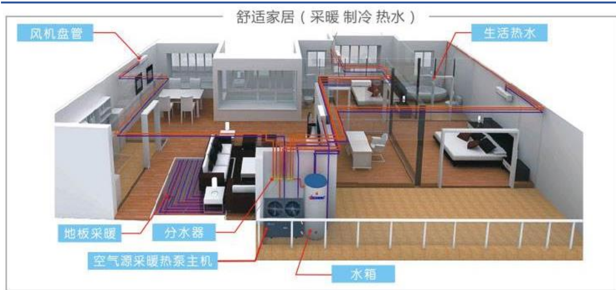
空气源热泵涉及室内较多管道的布局
