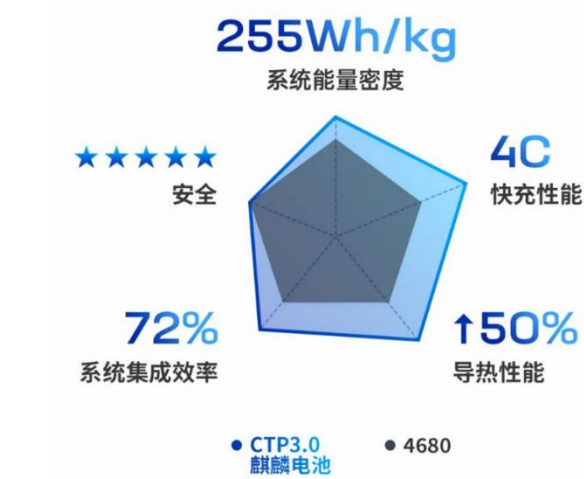
图：麒麟电池高镍三元版电池包能量密度255wh/kg
