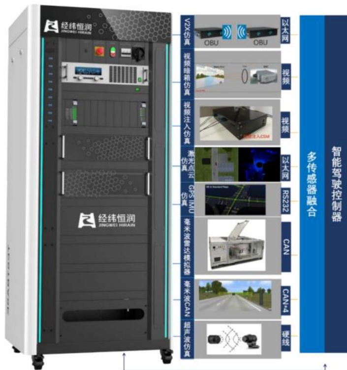
图 41：公司应用于智驾测试的仿真测试系统
