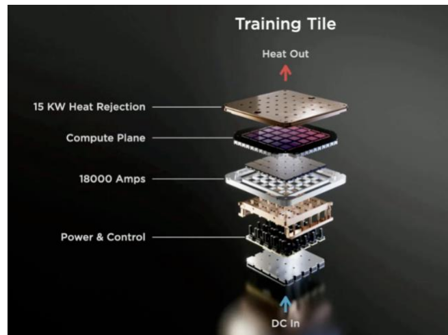
图：特斯拉DOJO计算机单个训练模块由25个D1芯片组成
