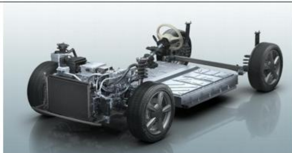
柠檬平台纯电架构的三合一集成化电驱系统
