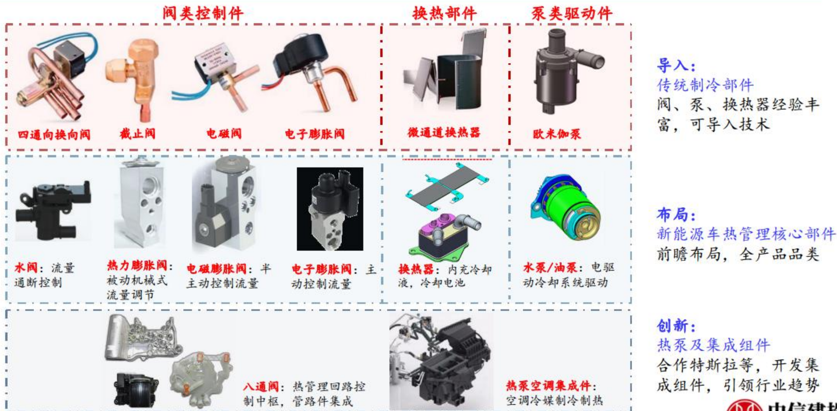
图：三花汽零新能源车热管理产品类型
