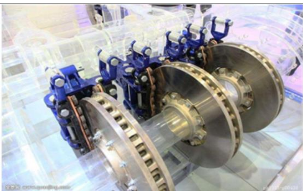
图 3：闸片与制动盘组成一对摩擦副
