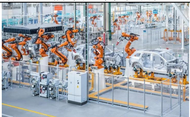
图表44. 江淮蔚来高端全铝车身生产线实景
