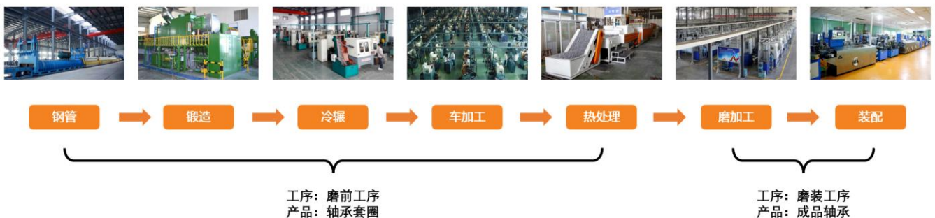
图 16：轴承生产流程中的磨前工序与磨装工序
