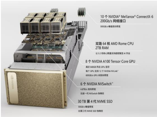
图 29: Nvidia DGX A100 服务器拆解图
