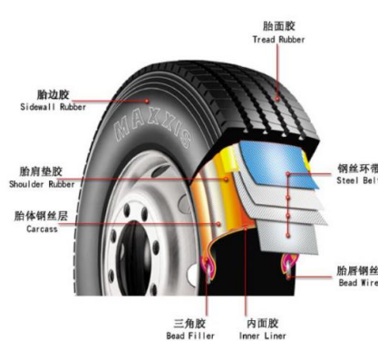
图32、子午线轮胎基本结构
