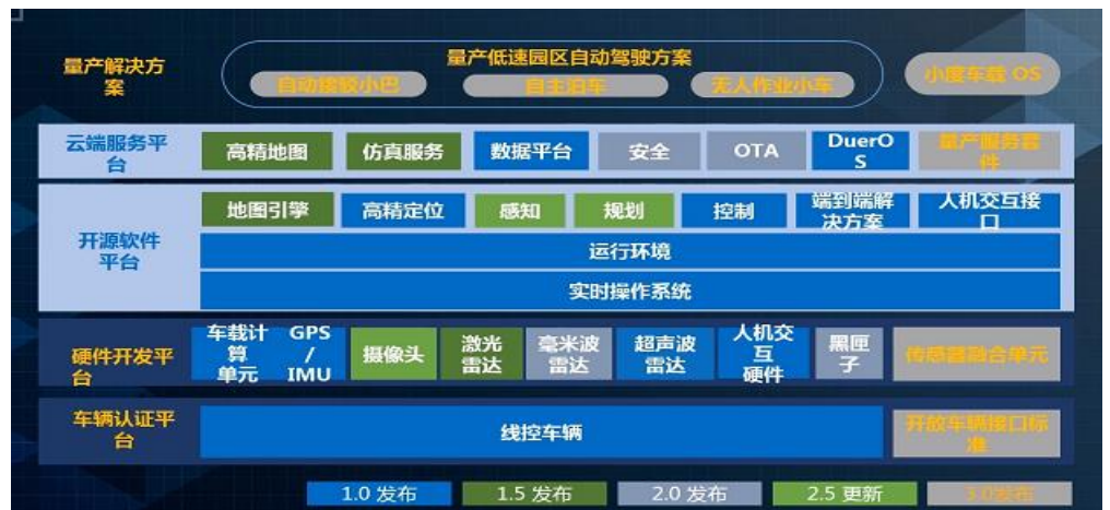
图34：Apollo 自动驾驶平台覆盖车辆认证、硬件开发、开源软件及云端服务等功能
