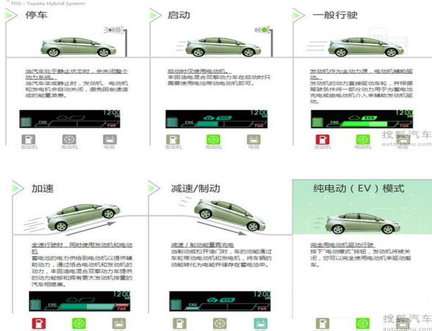
图：丰田THS混动系统行驶的工作模式
