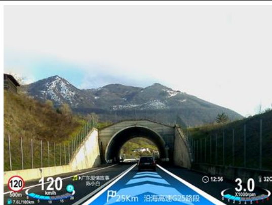
图 8 增强现实式抬头显示玻璃系统 (AR-HUD) 示意图
