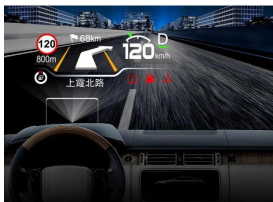
图 6 组合式抬头显示玻璃系统 (C-HUD) 示意图
