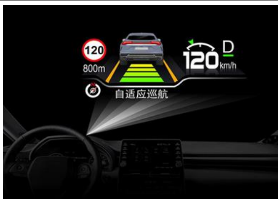
图 7 风挡式抬头显示玻璃系统 (W-HUD) 示意图
