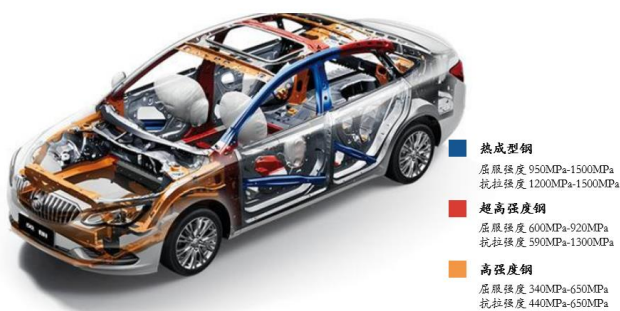
图表 51. 全新英朗车身结构件强度
