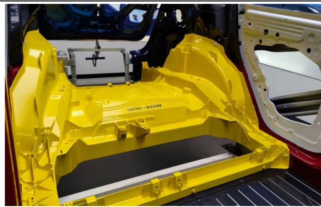
图表 19. 特斯拉 Model Y 一体铸造后地板实物图
