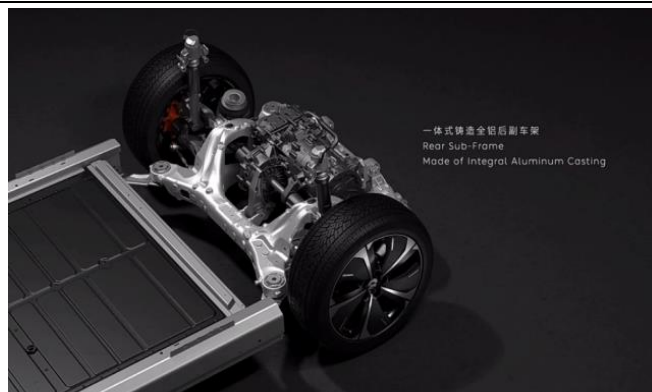
图表 23. ES7 一体式铸造全铝后副车架
