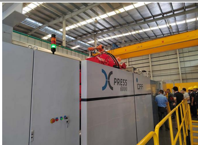
图表 55. 南通工厂成功试模的 6000T 压铸岛
