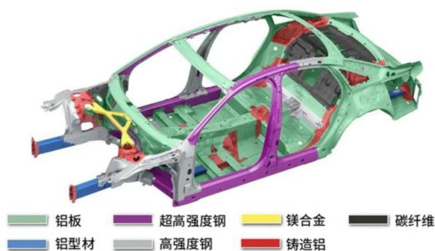
图表 8. 全新奥迪 A8 (D5) 车身采用多种材料
