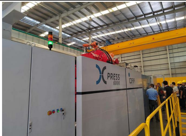
图表 78. 南通工厂成功试模的 6000T 压铸岛
