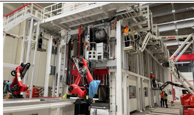
图表 13 柏林工厂超大型压铸机
