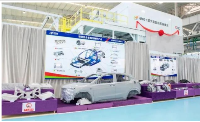
图表 88. 6800T 超大型一体化铝合金后地板试制成功
