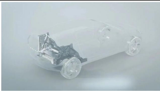
图表 28. 沃尔沃后地板一体压铸位置图
