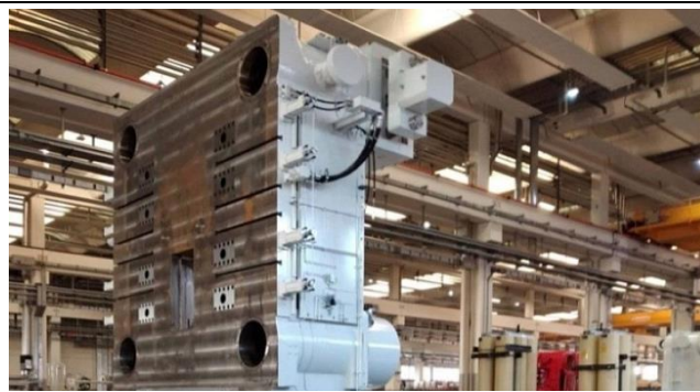
图表 21. 9000T 压铸机落地特斯拉工厂
