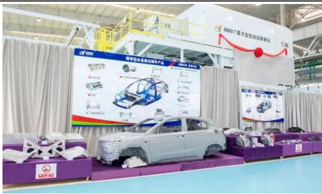
图表 57. 6800T 超大型一体化铝合金后地板试制成功
