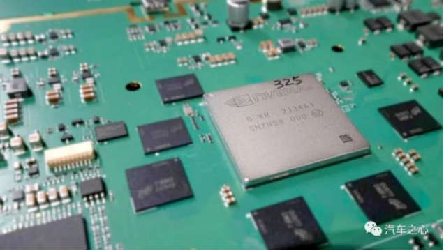
图表19 德赛西威基于 OrinX 的域控制器电路板
