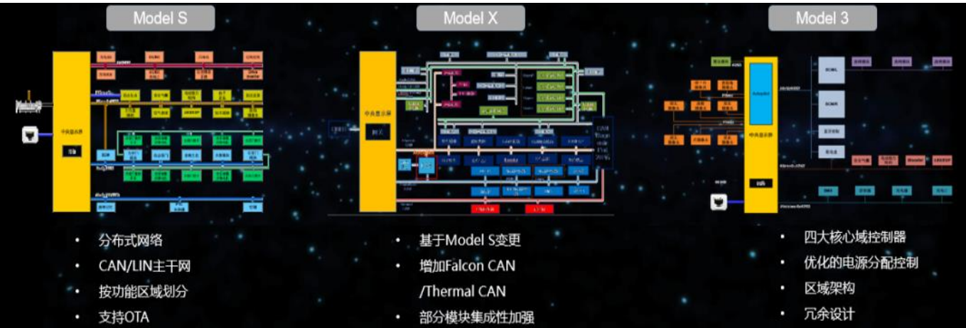
图表10 特斯拉电子电气架构演进历史
