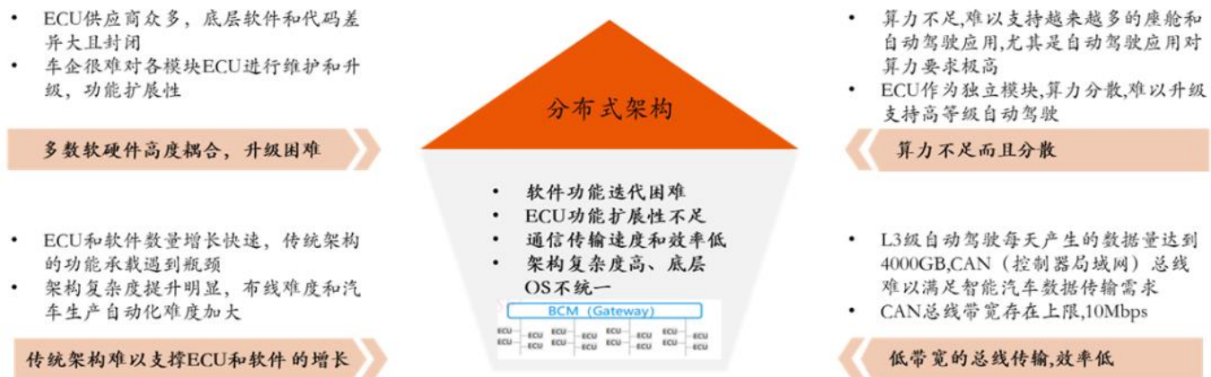
图表2 分布式的电子电气架构难以适应智能化发展趋势
