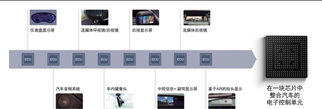
图表67 座舱域控制器在一块SOC芯片中整合座舱内离散电子控制单元
