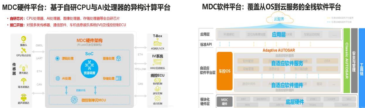
图表53 华为 MDC 硬件架构、软件架构
