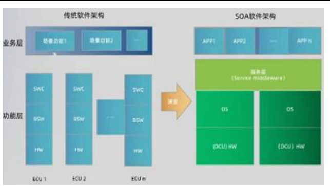
图表6 从分布式到域控，车辆软件架构变迁
