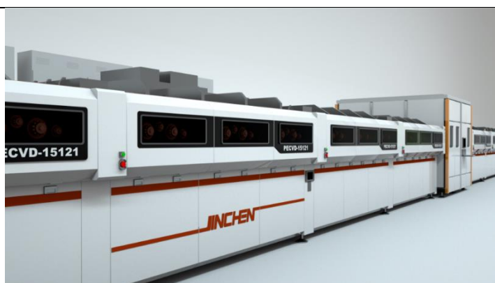
图 1：金辰股份 HJT PECVD 设备示意图
