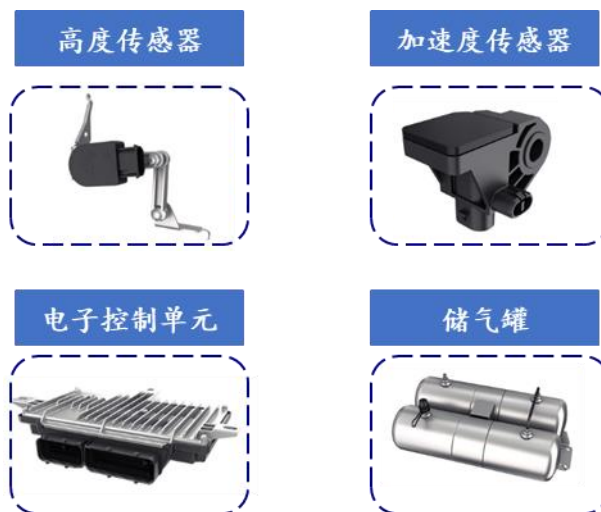
图 22：空悬其他结构——传感器、控制单元、储气罐
