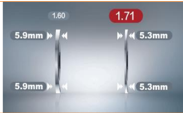
图 29: 1.60、1.71 折射率非球面树脂镜片的比较
