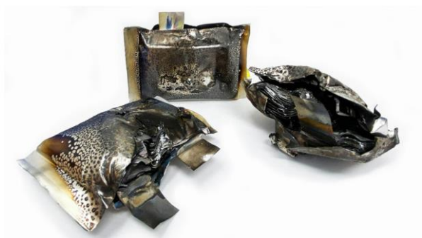
图5：传统锂电池的针刺实验结果（毁坏）
