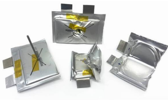
图6：复合锂电池的针刺试验结果（相对完好）
