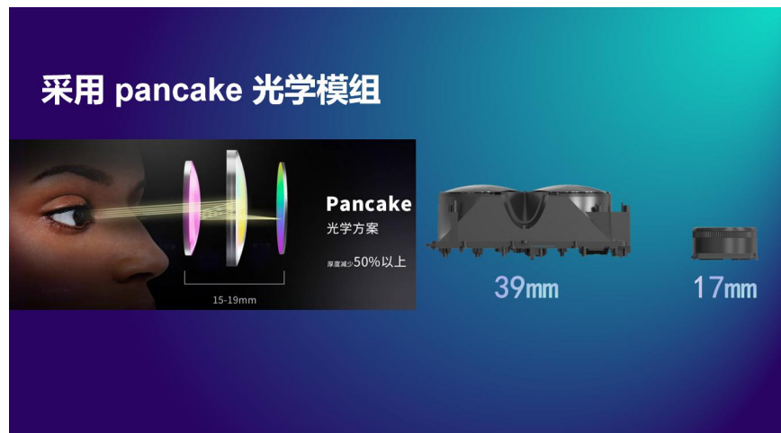
图 2: Pancake 光学模组示意图
