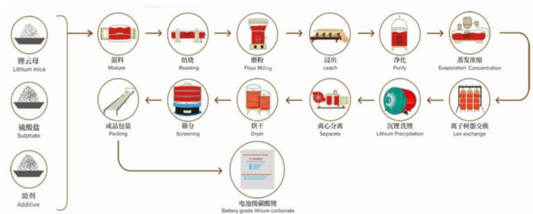
图 42：公司云母提锂工艺流程
