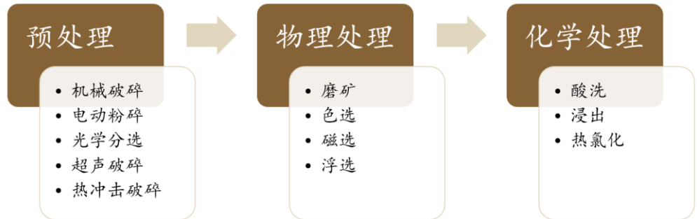
图 4：高纯石英砂制备工艺有预处理、物理处理、化学处理三个阶段
