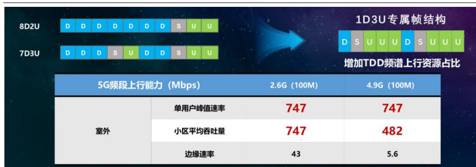
图 82: 1D3U 上行专属帧结构示意图
