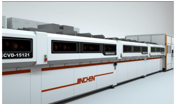
图 2：金辰股份 HJT PECVD 设备示意图
