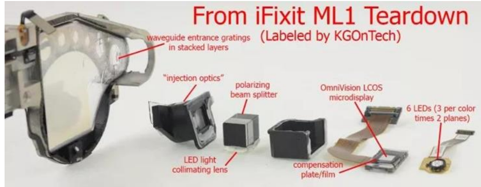
图表 15: Magic Leap One 光学元件拆解
