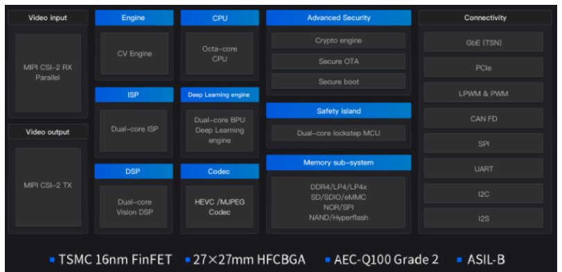
图表 24: 地平线征程@5 芯片架构
