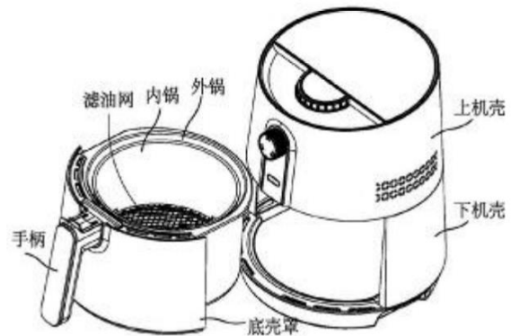
图 11：空气炸锅内部结构
