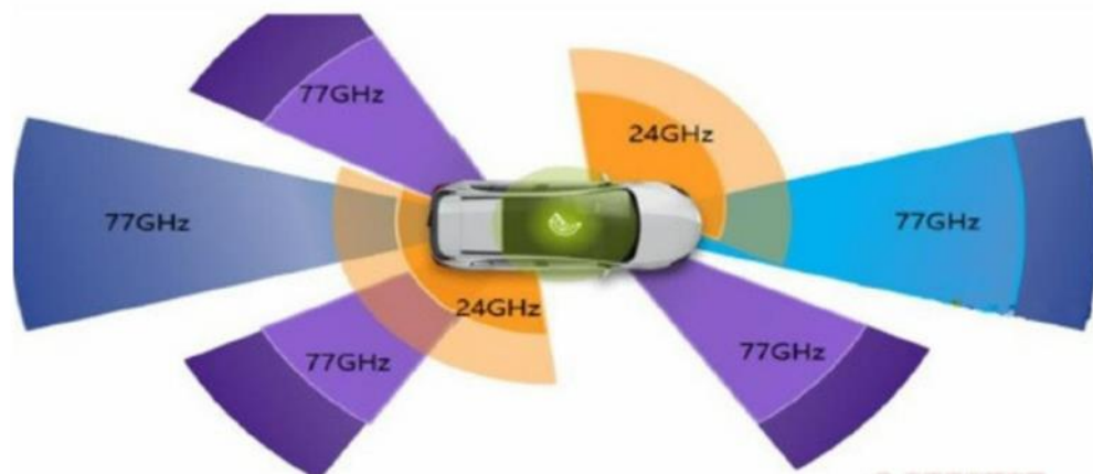
图表 21. 未来一台车上将会搭载更多的 77GHz 毫米波雷达
