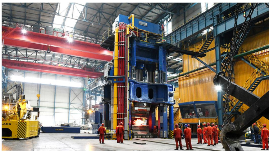
图表 3 公司新建 7000 吨快锻机热负荷试车喜获成功
