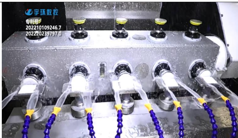
图14：宇环数控磨床、抛光机支持多工位加工
