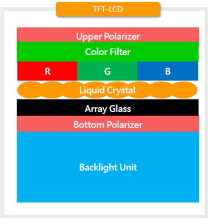
LCD面板结构图
