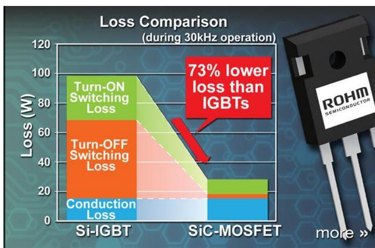
图 38、碳化硅器件高频特性好，能量损失低
