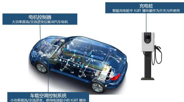
图 12、IGBT 在新能源汽车中应用
