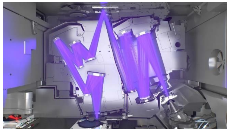
图：EUV全反射投影系统
