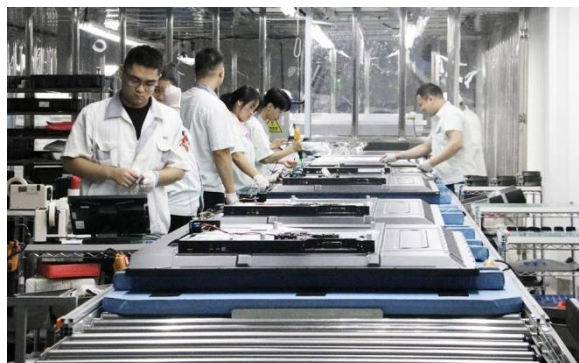
图44：公司商用智能交互显示产品整机生产线
