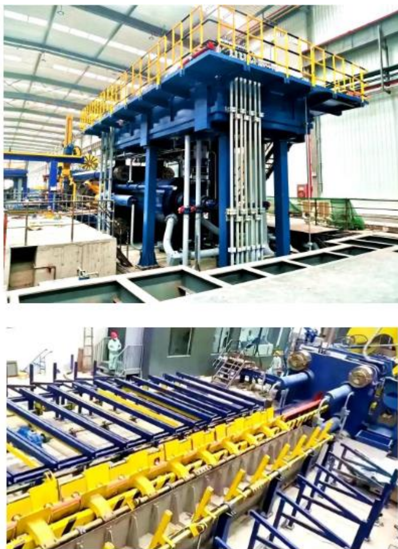
图表 5 宝钛股份 6300 吨钛合金挤压生产线热负荷试车成功
