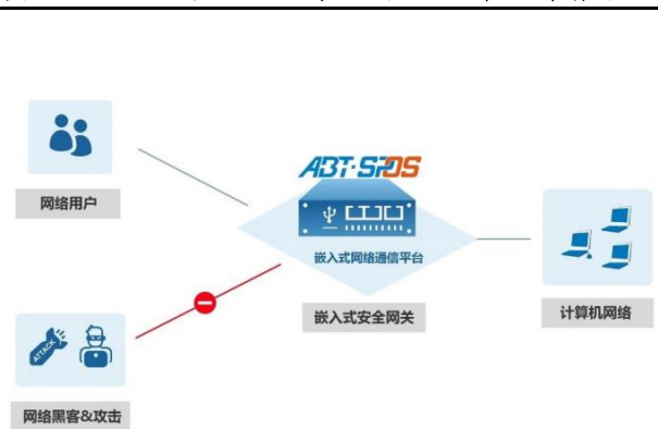
图表33. 嵌入式安全网关产品在网络中的部署示例
