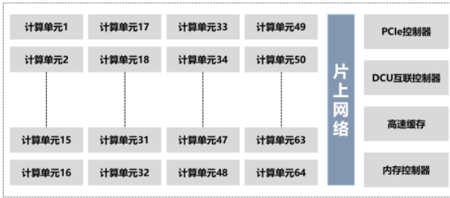
图 7：海光 DCU 基本组成架构
