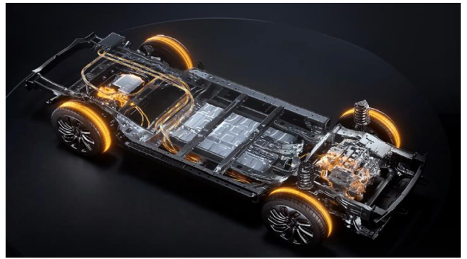
图表 29 问界 M7-HUAWEI DriveONE 纯电驱增程平台
