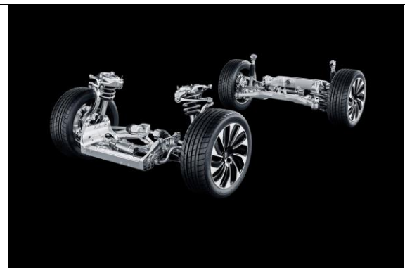
图表 21 问界 M5 前双叉臂后多连杆独立悬架
