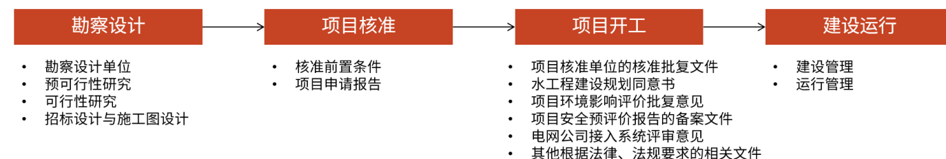
图 11：抽水蓄能电站开发建设流程
