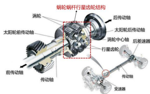
图35：中央差速用托森差速器构造图
