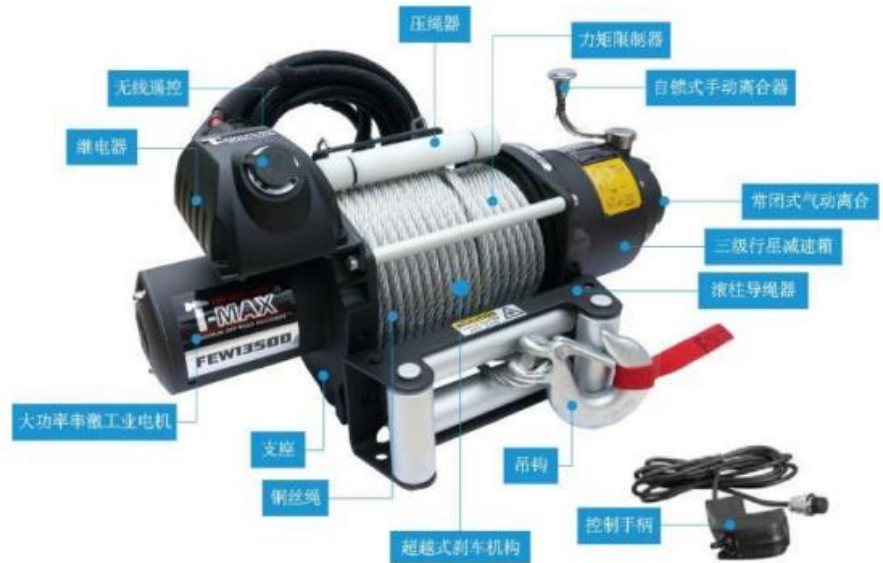
图 8. 电动绞盘结构示意图
