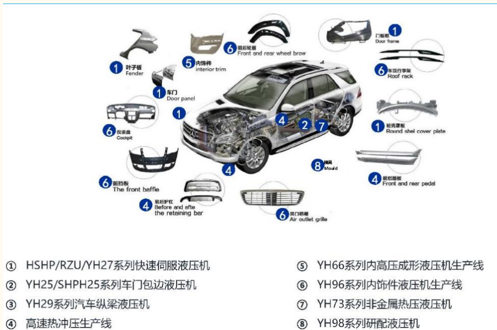
图表 13: 公司液压机生产线可应用于生产汽车多个零部件
