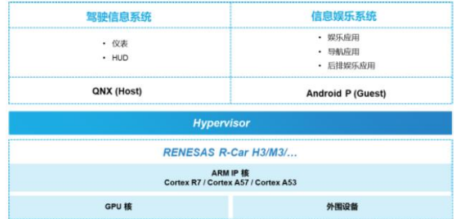
图 33：公司的虚拟化座舱解决方案可支持 QNX 和 Android 两套操作系统
