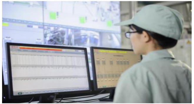
图18: 操作员在中控室内通过 WinCC 系统查看生产线生产状况
