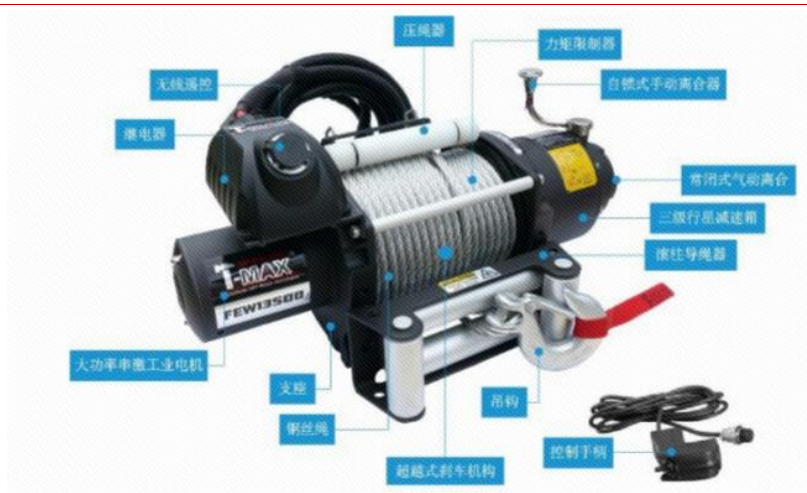
图 3：车载绞盘产品结构图
