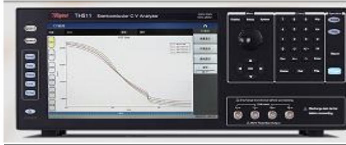
图24：2022H1 公司推出 TH510 系列半导体器件 C-V 特性分析仪
