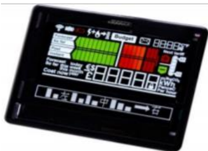
图9：单色液晶显示模组是对显示器的进一步组装
