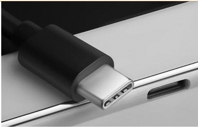
图 14: Type-C 接口示意图
